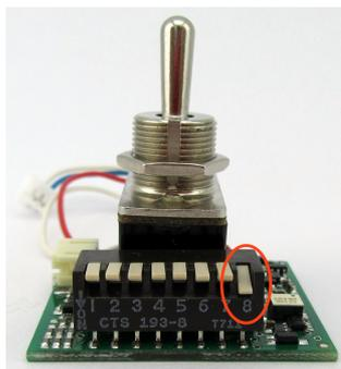
Pour une protection optimale de vos piles ou accumulateurs vous pouvez régler le circuit de protection: les accumulateurs doivent être protégés contre les décharges profondes, les piles peuvent être vidangées plus lourdement et les fuites précoces peuvent parfois être reportées.
